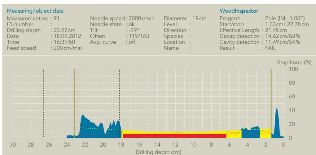
La figura muestra la gráfica desplegada por el módulo "WoodInspector" después de analizar un poste de madera con claros signos de pudrición en su interior.
